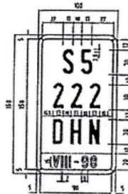
Matrícula ciclomotores temporal empresas (Vehículos no matriculados) Fondo rojo. Caracteres blanco mate Banda: Fondo blanco. Caracteres rojo mate adhesivos
